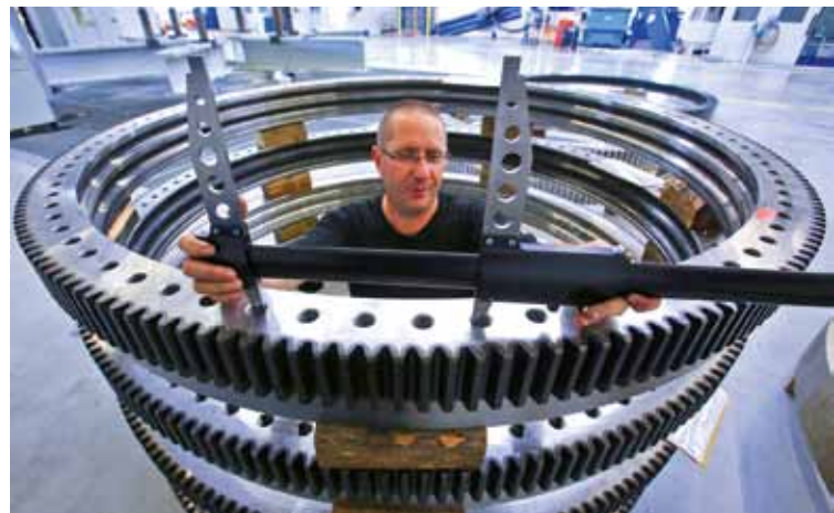
Die Hanse Drehverbindungen GmbH fertigt in Wismar aus nahtlos gewalzten Ringen Großwälzlager. Foto: Jens Büttner
