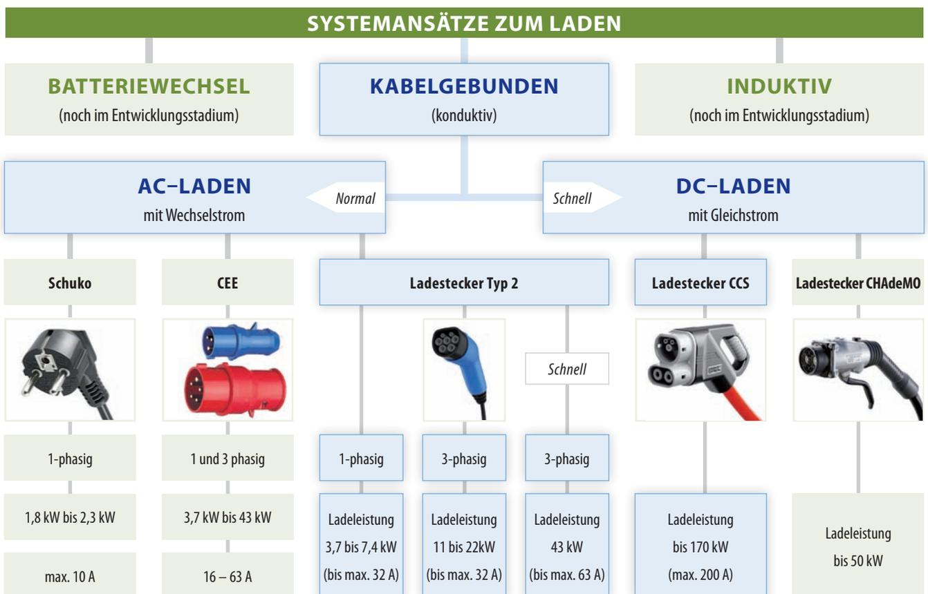
**Vorzugslösung gemäß EU-Richtlinie 2014/94/EU und Ladesäulenverordnung (LSV) des BMWi für das kabelgebundene Laden (konduktives Laden)**
