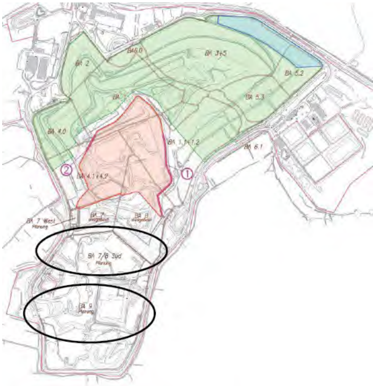
Abbildung 10: erforderliche Basisabdichtung für weitere Verfüllbereiche
